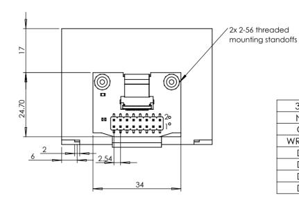
2 3v3 GND NC RES CS DC WR/RW RD/E D1 D0 D3 D2 D5 D4 D7 D6
